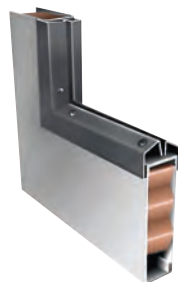
Moulure à vitre, modèle sandwich , Calibre 18 (1,1mm/0,044 po). Offerte pour le verre 6,3mm (1/4 po) à 25,4 mm (1 po) d'épaisseur (option SK).
