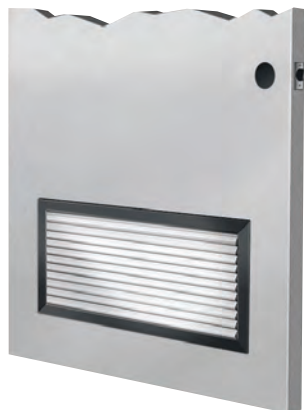
Persienne modèle sandwich , lames en Y inversé, deux sections aux coins soudés, 50 % d'aération, calibre 18 (0.044 po/1.1 mm).
