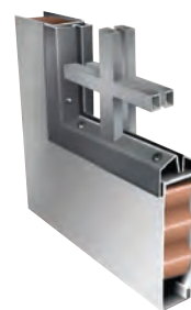
Moulure à vitre, modèle sandwich avec meneaux , calibre 18 (0.044 po/1.1 mm). Offerte pour le verre 6,3mm (1/4po) et 12,7 mm (1/2po) d'épaisseur.
