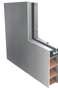
Moulure à vitre intégrée sans joint apparent , Soudée au laser, offerte pour le verre 6,3 mm (1/4 po) à 25,4 mm (1 po) d'épaisseur.
