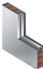
Moulure à vitre intégrée , calibre 16 (0.056 po/1.4 mm). Soudée au laser, offerte pour le verre 6,3 mm (1/4 po) à 25,4 mm (1 po) d'épaisseur.
