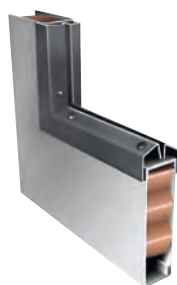
Moulure à vitre, modèle sandwich , Calibre 18 (1,1 mm/ 0,044 po). Offerte pour le verre 6,3 mm (1/4 po) à 25,4 mm (1 po) d'épaisseur (option SK).
